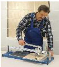
Narzędzia do cięcia płytek. Stabilizowanie płytki przy pomocy prowadnicy (culagi).
