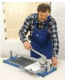
Narzędzia do cięcia płytek. Stabilizowanie płytki przy pomocy prowadnicy (culagi).
