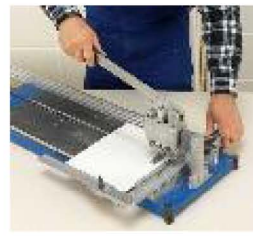
Narzędzia do cięcia płytek. Stabilizowanie płytki przy pomocy prowadnicy (culagi).
