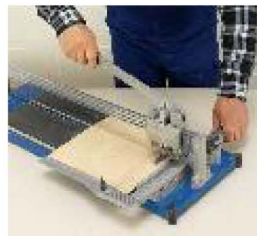
Narzędzia do cięcia płytek. Stabilizowanie płytki przy pomocy prowadnicy (culagi).
